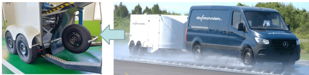
圖 4、輪胎濕地抓地力檢測設備
