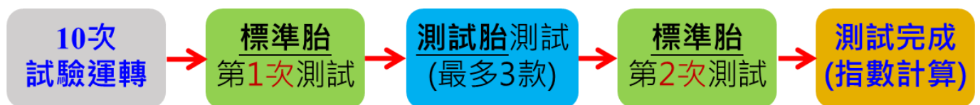
圖 1、濕地抓地力測試流程圖
